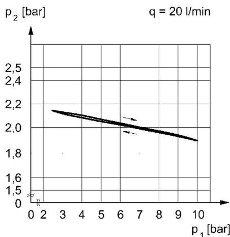
p1 = Betriebsdruck p2 = Sekundärdruck q = Durchfluss
