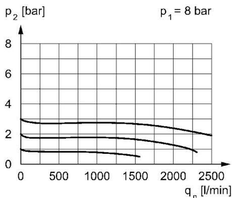
p1 = Betriebsdruck p2 = Sekundärdruck  $q_n$  = Nenndurchfluss
