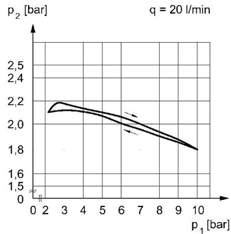
p1 = Betriebsdruck p2 = Sekundärdruck q = Durchfluss
