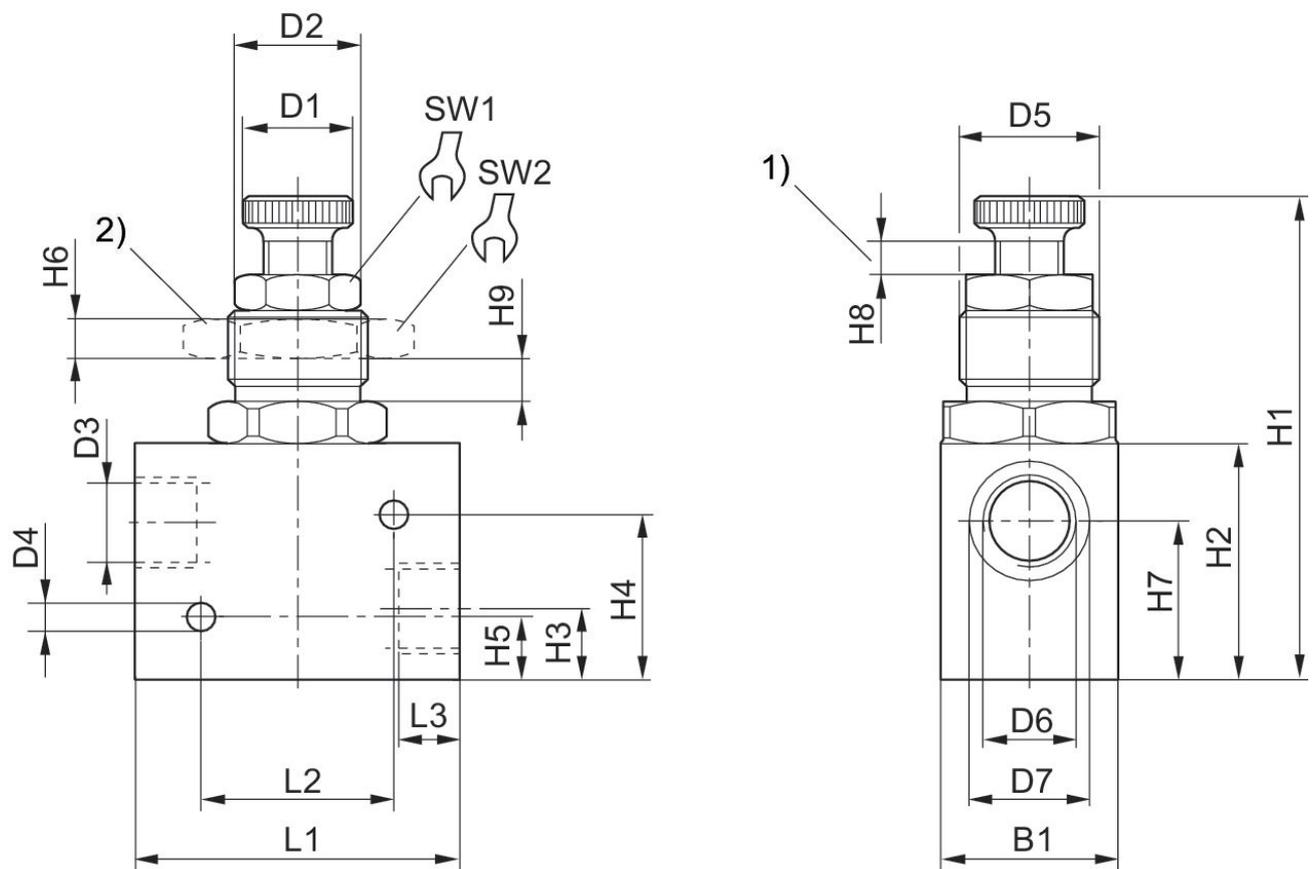
1) ajuste del estrangulador 2) tuerca para el montaje en el panel
