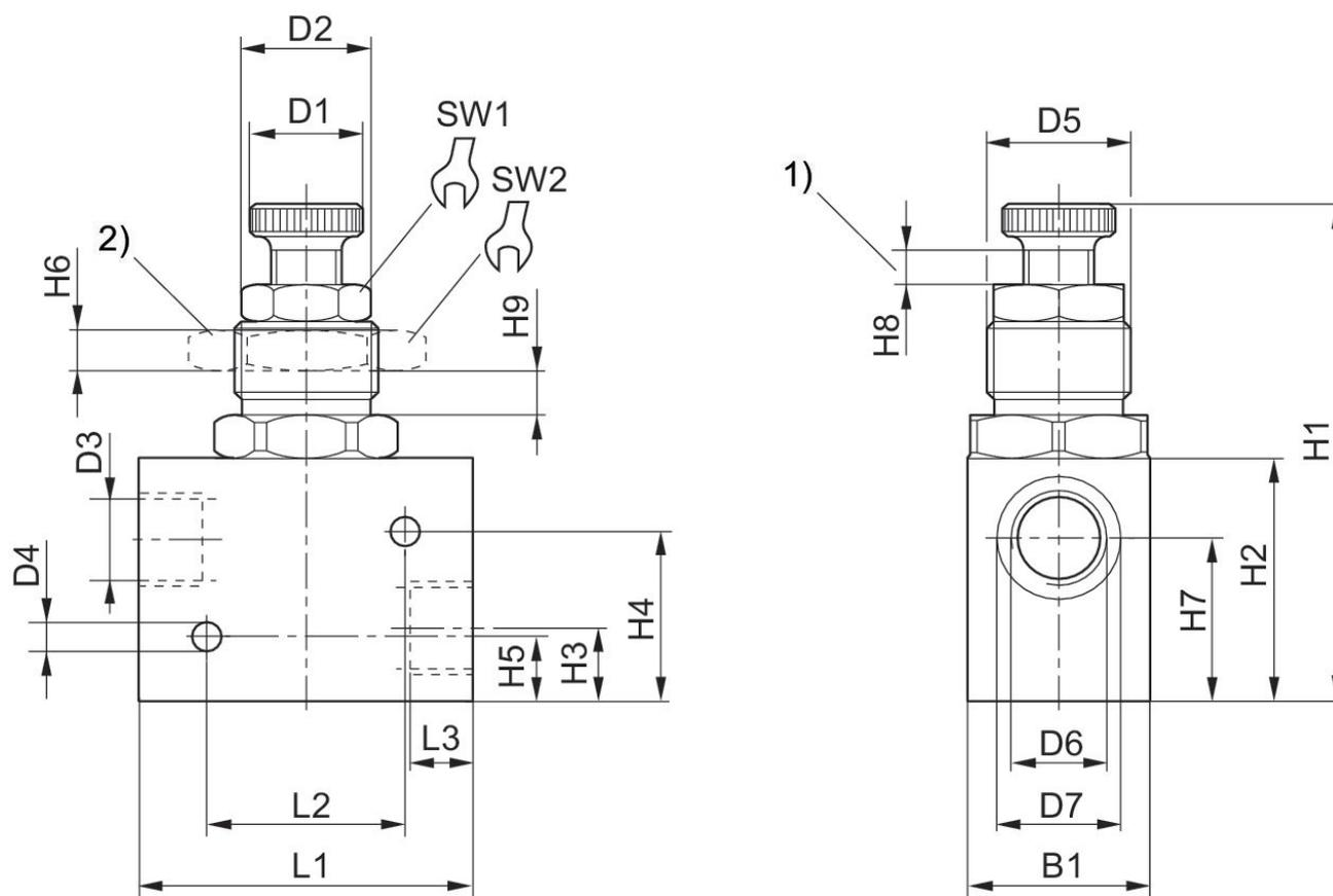
1) Course de réglage du limiteur 2) Écrou pour montage de tableau de commande
