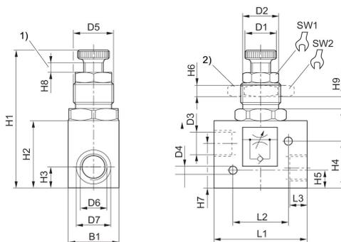
1) faixa de ajuste 2) porca para montagem de painel elétrico
