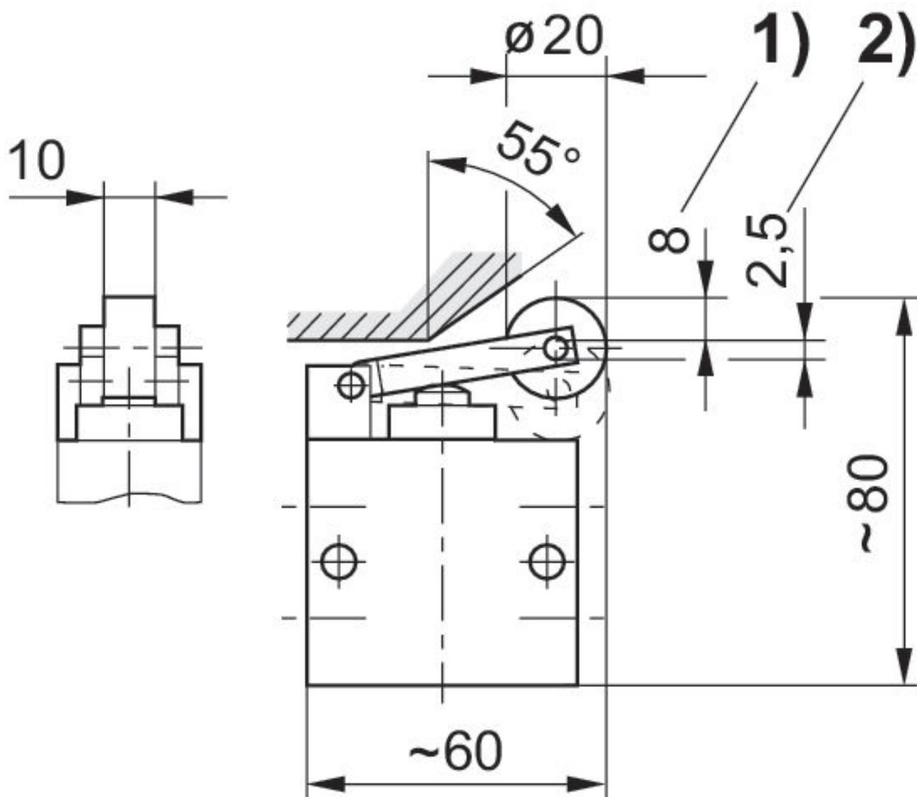
1) corsa di azionamento 2) sovraccorsa
