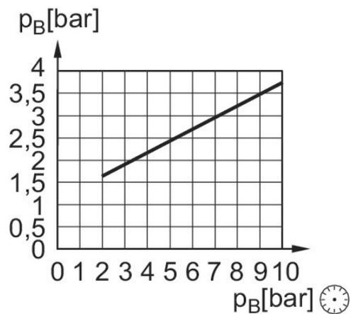
Pe = presión de pilotaje externa, mín.
