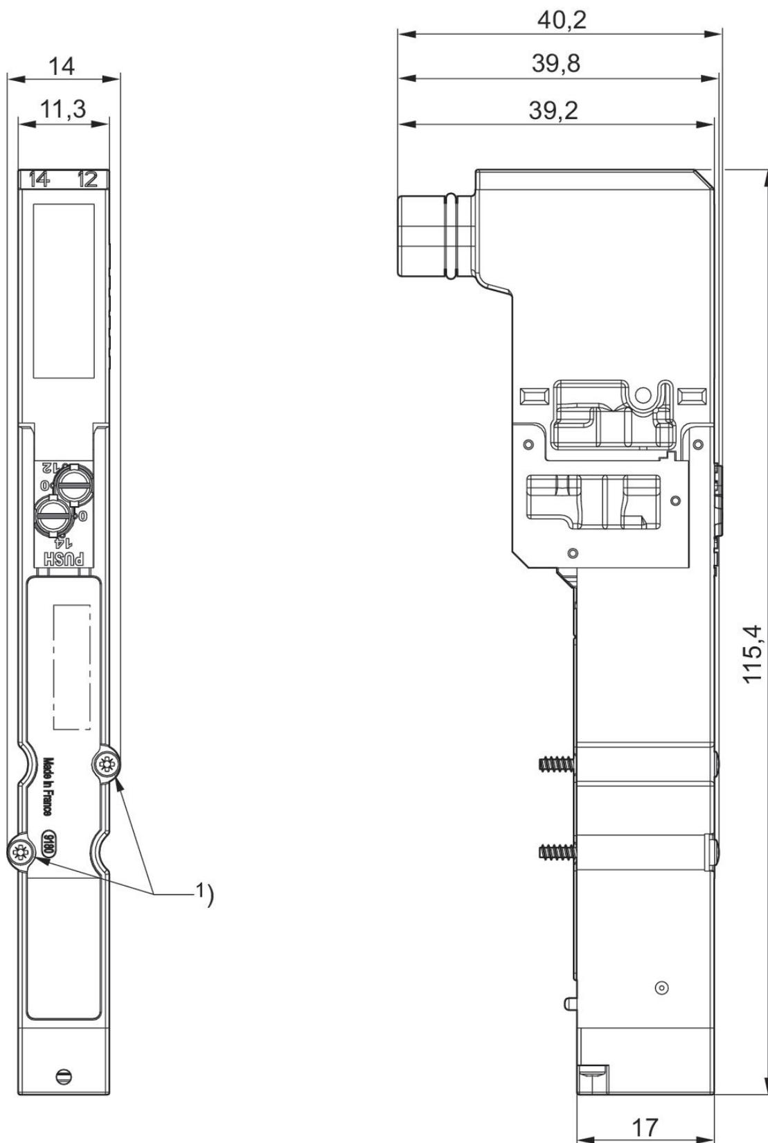
1) parafuso de fixação: fenda em cruz DIN EN ISO 4757-Z0 torque de aperto para parafuso de fixação [Nm]: 0,25
