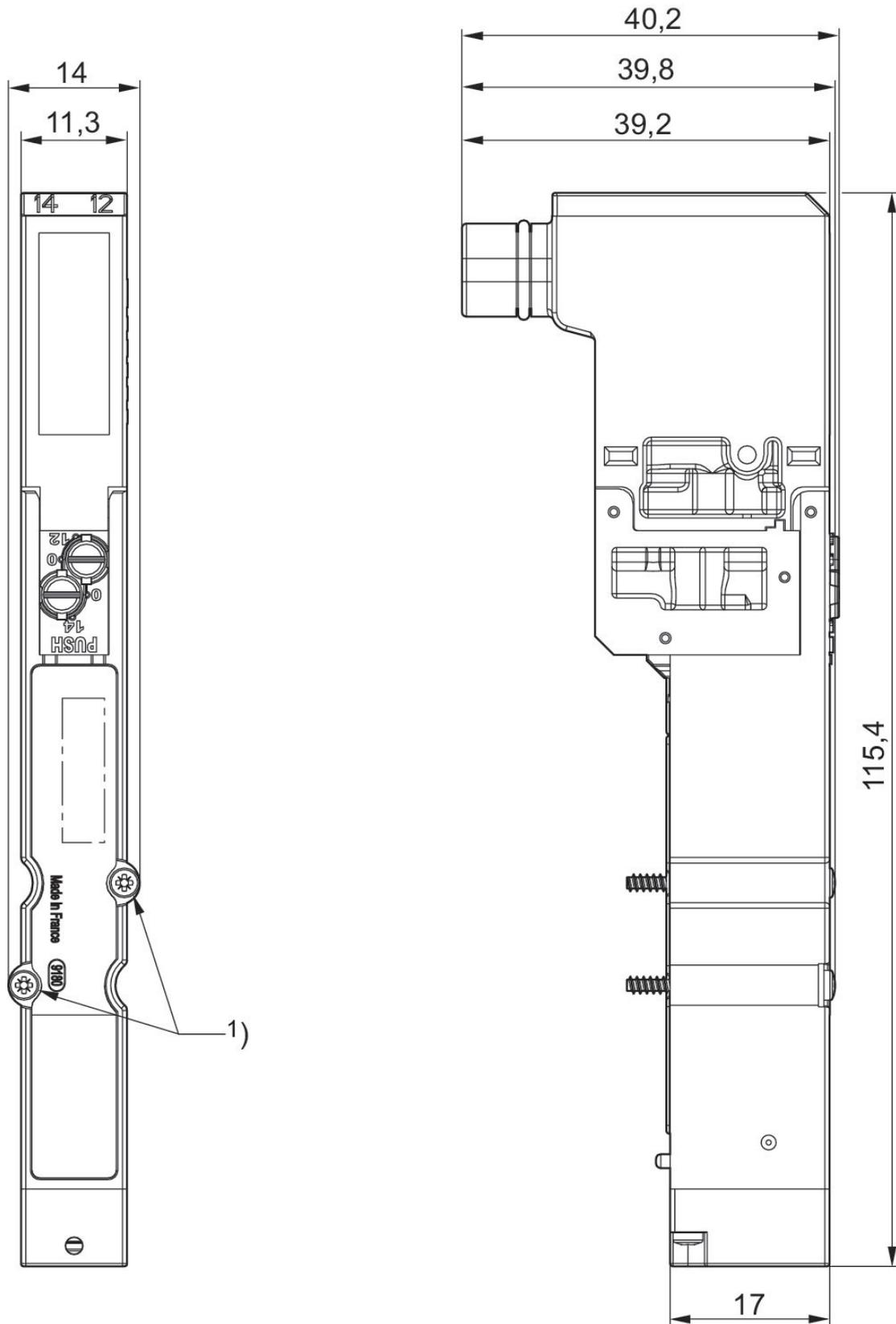
1) Befestigungsschraube: Kreuzschlitz DIN EN ISO 4757-Z0 Anzugsmoment für Befestigungsschraube [Nm]: 0,25
