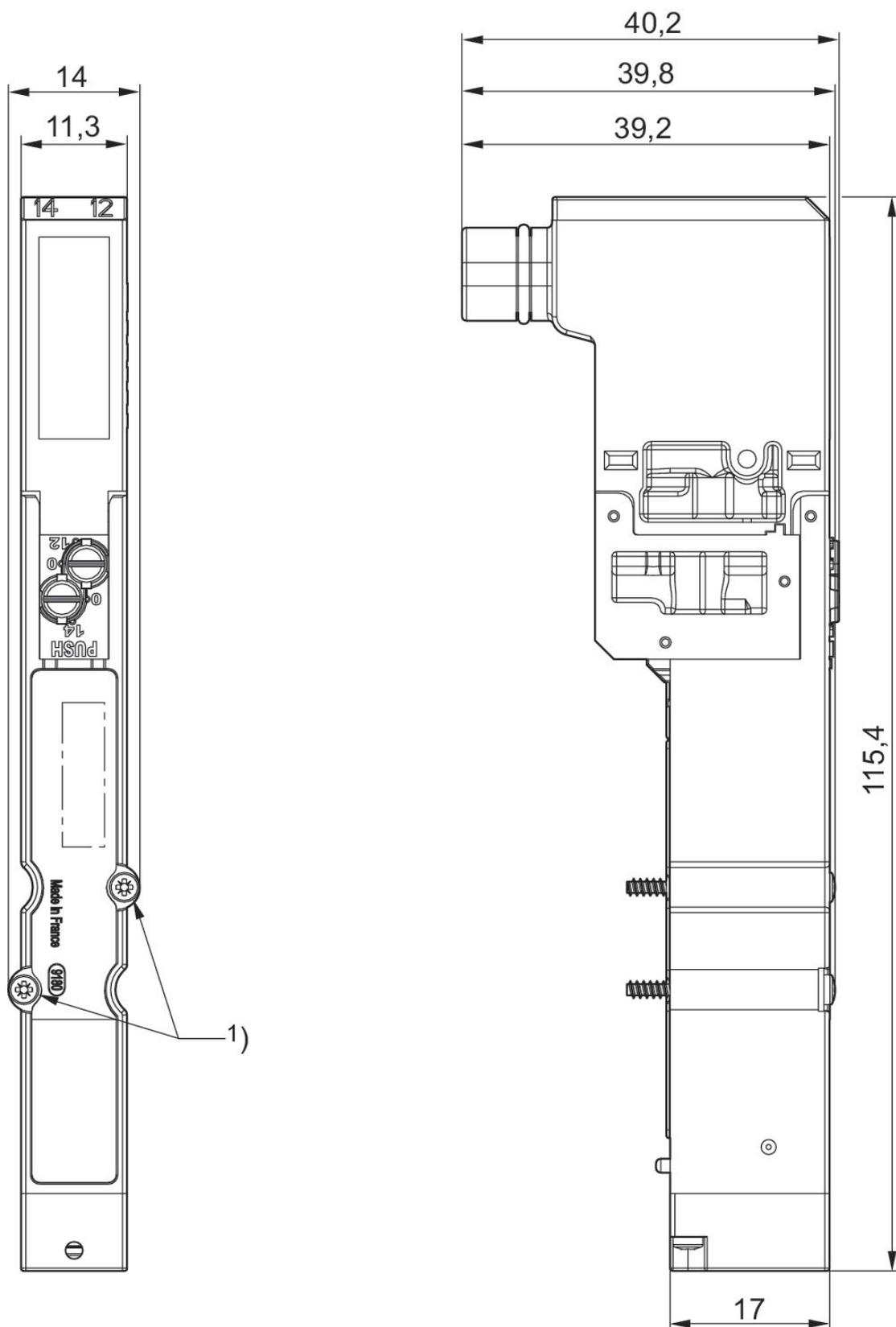
1) vite di fissaggio a croce DIN EN ISO 4757-Z0 coppia di serraggio per vite di fissaggio[Nm]: 0,25
