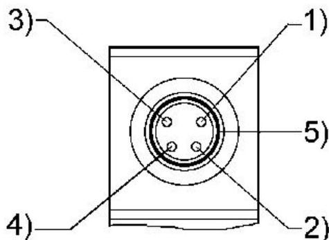
PIN-Belegung: 1) PIN nicht belegt 2) PIN nicht belegt 3) 0V 4) 24 V 5) LED
