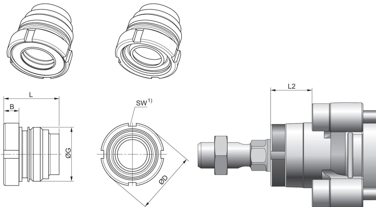
1) DIN 1810 A 規格のフックレンチで取付け可能
