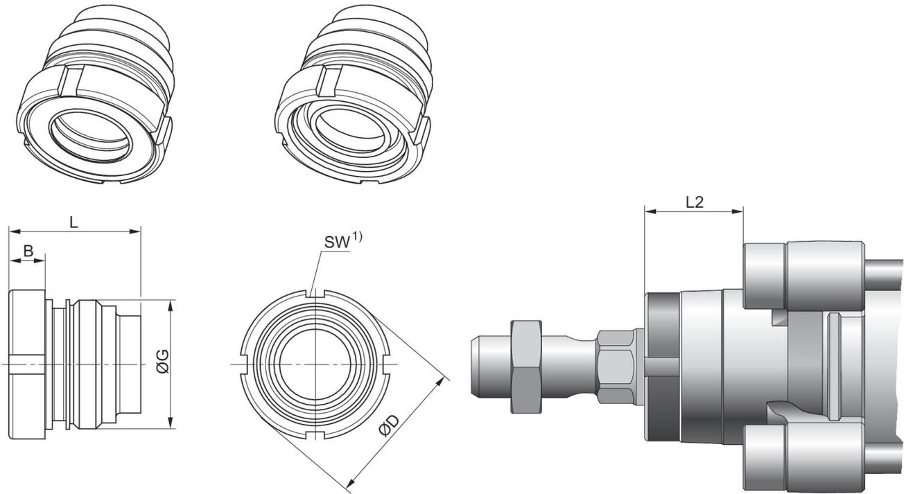
1) Se puede montar con una llave para tuercas ranuradas según DIN 1810 A
